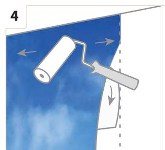
4. Začněte lepit první pás. Nalepujte pás po pásu pomalým stahováním podkladového papíru směrem dolů.
