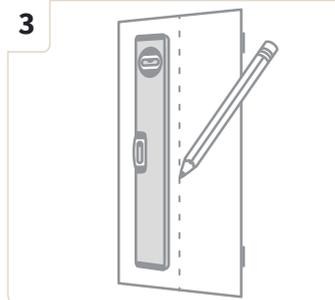
**3** Zeichnen Sie für das exakte Anbringen eine senkrechte Hilfslinie in der Mitte des Türblattes.
