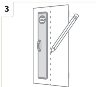
3 Teken voor exact aanbrengen verticale hulplijnen in het midden van het deurblad.
