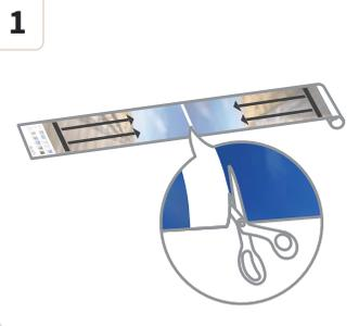
**1** Schneiden Sie die Bahnen zu. Bemessen Sie das Motiv etwas größer als Ihr Türblatt. Beachten Sie, dass die zweite Bahn auf Kopf steht und gedreht werden muss.
