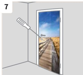
**7** Schneiden Sie die Tapete an der Position der Türklinke ein und montieren Sie diese wieder.
