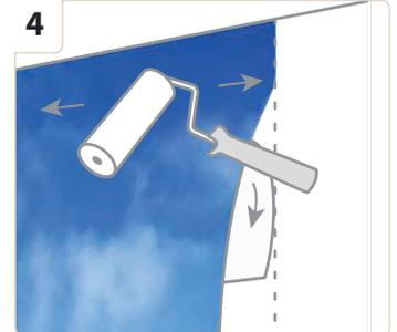
**4** Beginnen Sie mit dem Verkleben der ersten Bahn. Arbeiten Sie Stück für Stück, indem Sie das Trägerpapier langsam nach unten abziehen.
