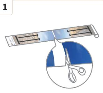
1 Snijd de banen op maat. Bereken het motief iets groter dan uw deurblad. Let erop, dat de tweede baan ondersteboven staat en gedraaid moet worden.
