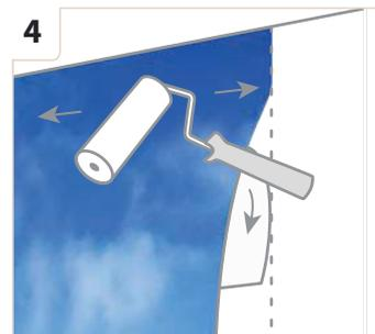
4 Bestrijk de 1e baan gelijkmatig met plaksel. Werk tot in de hoeken. Klap het onderste derde deel van de behangbaan voorzichtig in zonder het te knikken.
