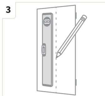
3 Tracez une ligne perpendiculaire pour positionner exactement les lés au milieu du panneau de porte.
