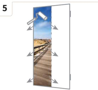
**5** Streichen Sie jede Bahn von oben nach unten glatt, so dass die Luft von der Mitte zu den Seiten entweichen kann.
