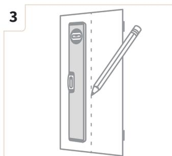
**3** Dibuje una línea de guía vertical en el centro de la hoja de la puerta para un ajuste exacto.
